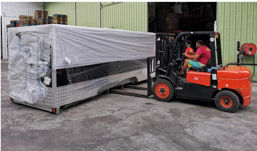
3 - dépoter la roulotte avec un elevateur (longue fourches) - il y a des roulettes amovibles à l'avant de la roulotte pour aider à la manoeuvre de sortie
